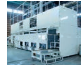
細かく砕いたチタンスクラップの脱脂、水洗い、乾燥を行う洗浄機（昭和メタル(株)直江津事業所）
