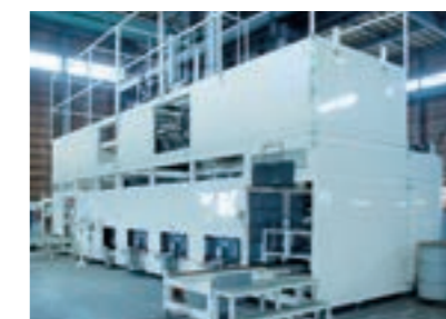
細かく砕いたチタンスクラップの脱脂、水洗い、乾燥を行う洗浄機（昭和メタル㈱直江津事業所）。
